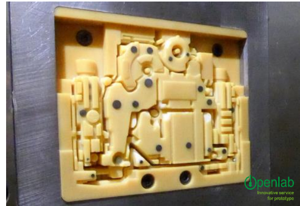
Exemple de moule d'injection imprimé en 3D sur une presse d'injection traditionnelle ©Openlab Schneider Electric
